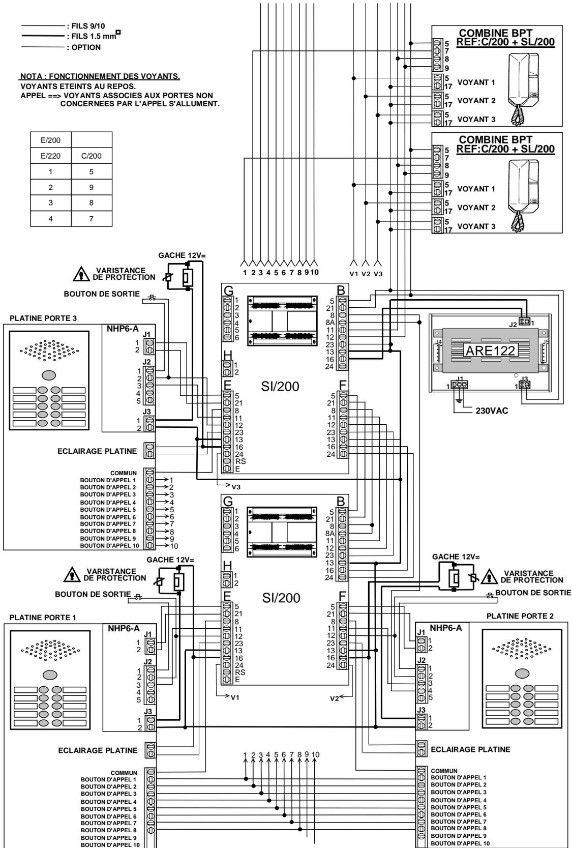
**RACCORDEMENT COMBINES BPT C/200 + SL/200, SI/200 ET MODULE HP/MICRO NHP6-A**
