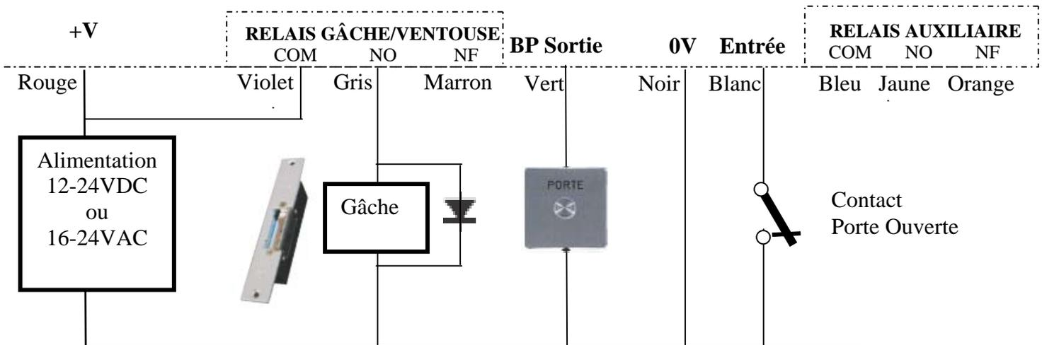
\* Attention : placer une diode de protection (alimentation continue) ou une varistance (alimentation alternative) aux bornes de la gâche ou de la ventouse.
