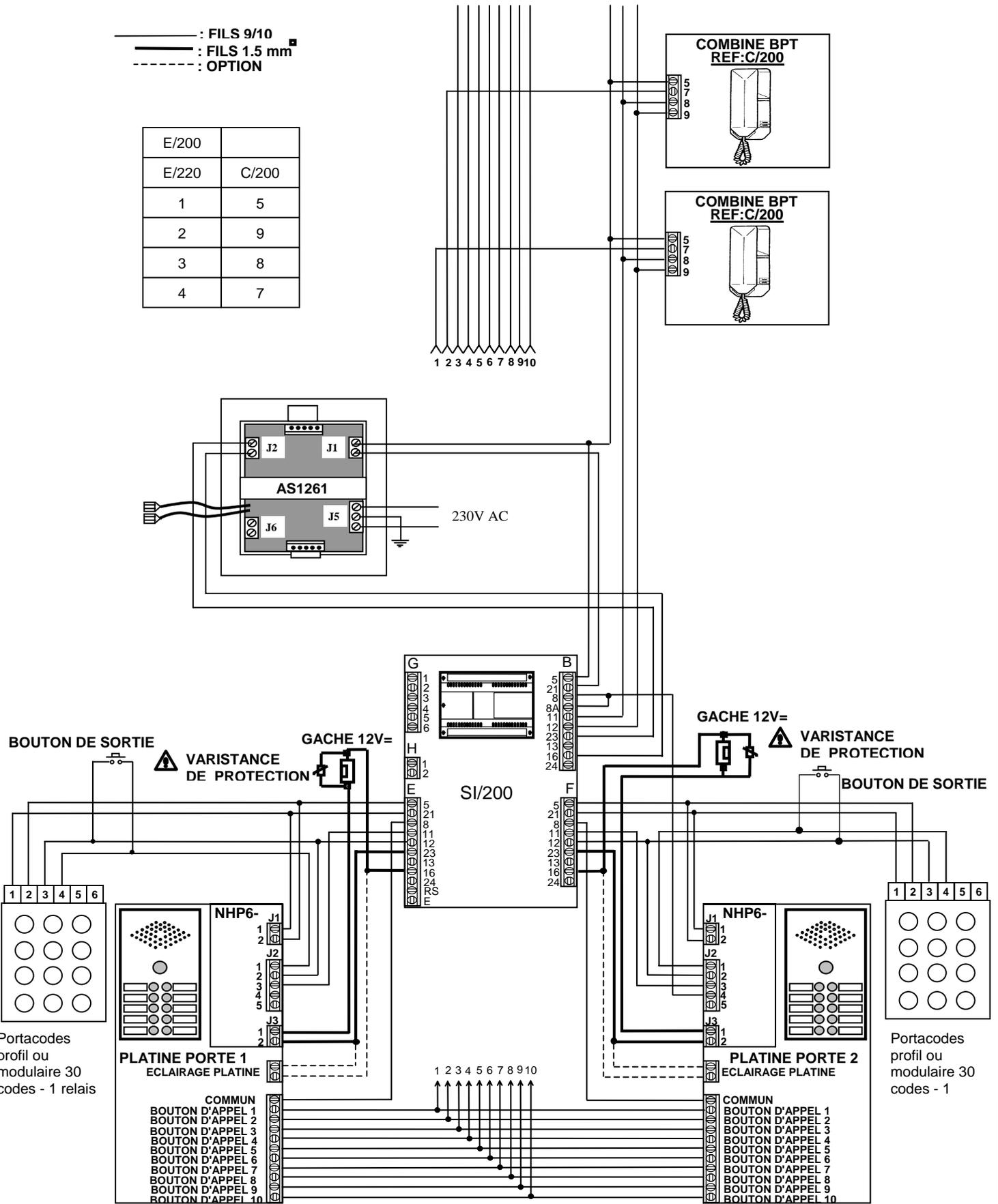
**RACCORDEMENT COMBINES BPT C/200, SI/200, ET MODULE HP/MICRO NHP6-A**
