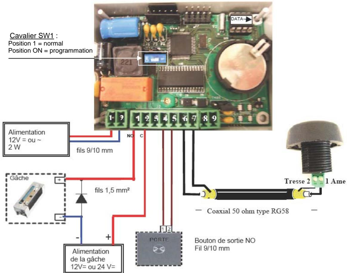
L'ensemble du câblage est de type TBTS (Très Basse Tension de Sécurité)
