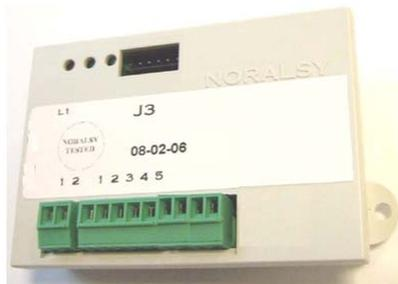
**Important :** l'attention de l'installateur est attirée sur le fait que VIGIK impose une distance minimale de 2 mètres entre la tête de lecture (en façade) et le module électronique (qui doit donc être installé à l'intérieur du bâtiment). Le non respect de cette règle annule la conformité VIGIK de l'équipement.
