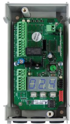
Récepteur HF gestion autonome avec afficheur
